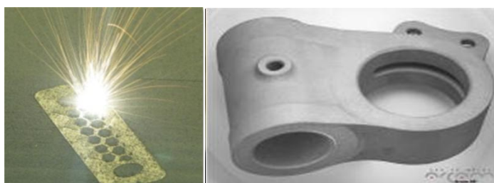
Figura 20. A la derecha proceso de SLM y a la izquierda pieza fabricada con EBM
