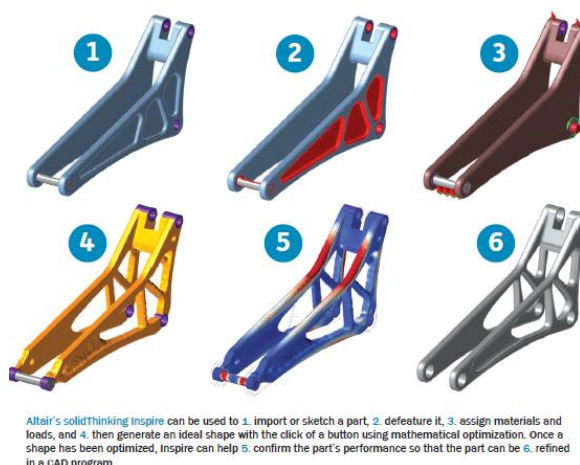
Figura 30. Ejemplo de optimización realizada con software OptiStruct
